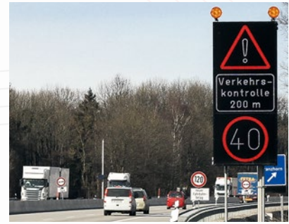
Configuration personnalisée variable de l'affichage à LED
