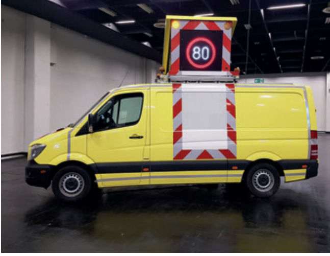
Generador de señal variable girado en 90 grados en el vehículo de escolta.
